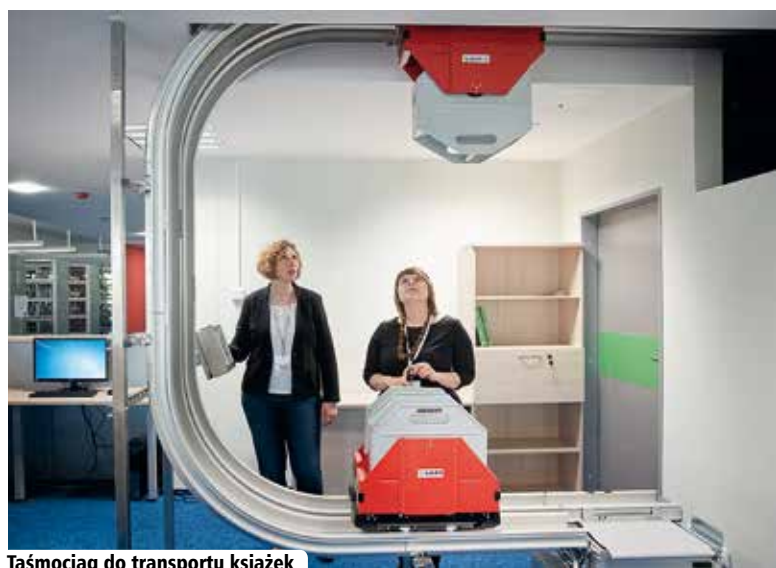
Taśmociąg do transportu książek
